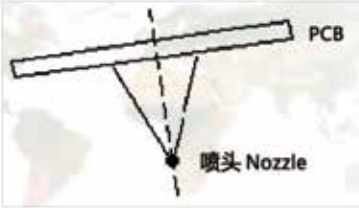
新型助焊剂喷雾方式 New Soldering Flux Method
